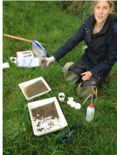
Abbildung 3: Reinigen und mehrmaliges Dekantieren der Proben.
